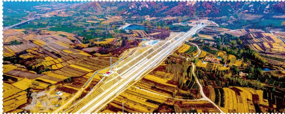
2. 平邑红西山弃土场变良田。完成功能后，弃土场周围被设置了 700 余延长米挡土墙，砌筑了 350 米永久性排水沟，“弃土山坡”进行了复垦绿化，低洼地也进行了“熟土”覆盖、平整，变成一马平川的良田。
